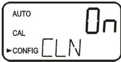
在“CLN”下按▲或▼键选择 ON，使其浊度监测器执行超音波自动清洗功能动作，再按 ↵ 键，即完成设定。原厂设定：ON。
